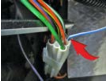
Рис. 3. LIN-шина в автомобиле Lada Priora (2013--)
