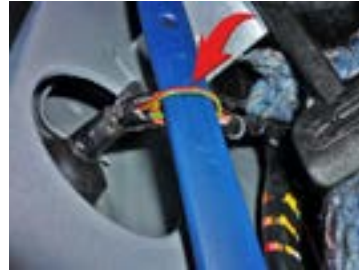
Рис. 4. LIN-шина в автомобилях Lada Granta, Kalina 2; Datsun on-DO, mi-DO
